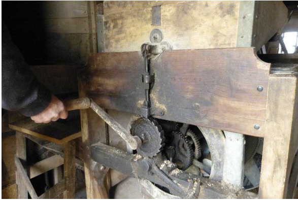
Le poussoir qui tressaute au passage des cames, c'est lui qui fait un bruit épouvantable.
