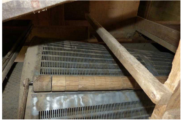
Dans le ventre de la machine, les différentes alvéoles qui sélectionnent les grains suivant leur longueur et leur grosseur.
